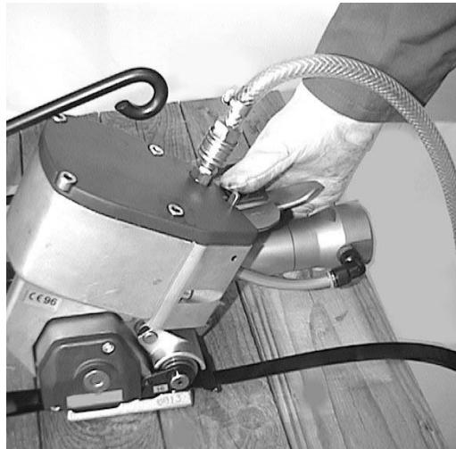
5. Lorsque la tension nécessaire du feuillard est atteinte, on appuie sur la touche „fermeture“ (b) jusqu'à ce que la fermeture soit effective et que l'on entende clairement le découpage du feuillard d'emballage derrière la fermeture.
