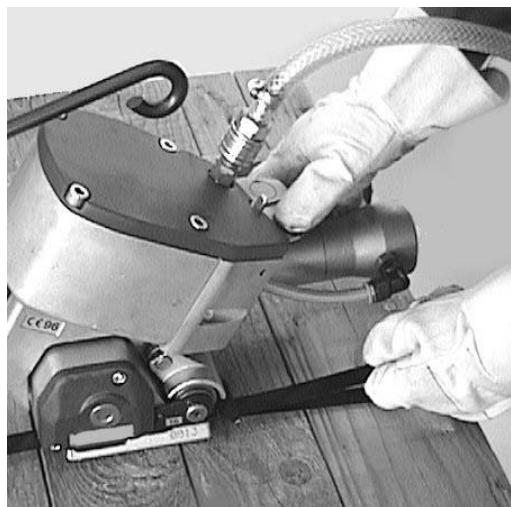
6. Saisir de la main gauche l'extrémité du feuillard sectionné, presser de la main droite le levier d'air (c) et le moteur à air comprimé (f) avant de basculer l'appareil vers la droite pour le sortir du cerclage.
