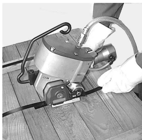
4. Appuyer de la main droite sur la touche "tendre le feuillard" (a) jusqu'à ce qu'il soit bloqué (g) en débloquant le dispositif, le moteur à air comprimé s'arrête). Sur les **appareils PKE** doté d'une roue libre intégrée, il est nécessaire de maintenir enfoncé la touche "tendre le feuillard" (a) jusqu'à ce que la tension souhaitée du feuillard soit atteinte.
