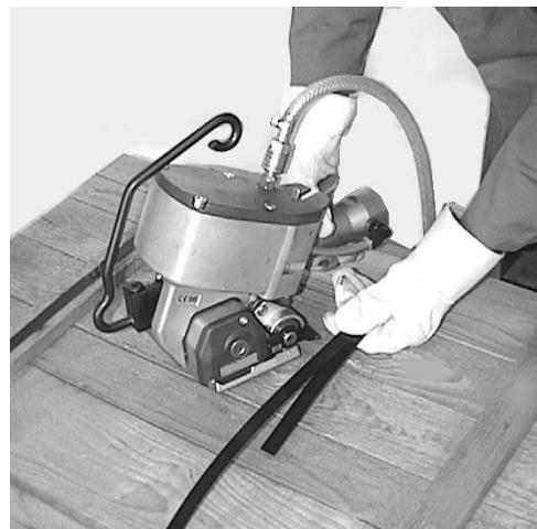
3. Maintenir de la main gauche les deux feuillards positionnés exactement l'un au-dessus de l'autre. Saisir de la main droite le levier d'air (**c**) et le moteur à air comprimé (**f**) avant de serrer. Pousser les deux feuillards jusqu'à la butée sur les parois latérales du boîtier dans l'appareil. Lors de cette opération, le feuillard inférieur doit dépasser légèrement de l'appareil à l'avant. Relâcher les leviers serrés (**c**) et le moteur (**f**).
