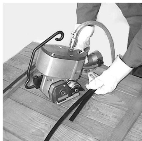
3. Mit der linken Hand beide exakt übereinanderliegenden Bänder festhalten. Lüfthebel (c) und Druckluftmotor (f) mit der rechten Hand umfassen und zusammen drücken. Beide Bänder bis zum Anschlag an der Gehäusewand seitlich in das Gerät schieben. Dabei muss das untere Band vorne etwas aus dem Gerät herausragen. Die zusammengedrückten Hebel (c) und Motor (f) loslassen.
