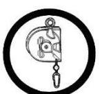
Verwenden Sie nur einen Federzug, der den Sicherheitsbestimmungen entspricht!
