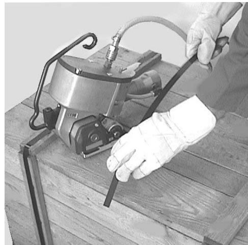
2. Bandende so weit durchziehen, bis es in der Mitte des Packstückes unter dem Oberband liegt und eine Handlänge hervor ragt.
